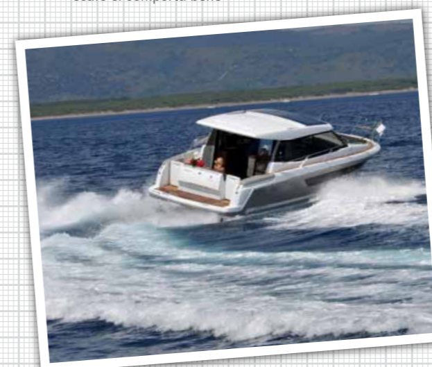
> Sopra, sul dritto il nuovo NC 11 si comporta bene, raggiunge la massima performance a 4000 giri e una velocità di 33 nodi. Sotto, anche in accostata stretta, lo scafo si comporta bene
