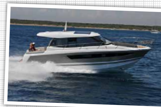
> Sopra, sul dritto il nuovo NC 11 si comporta bene, raggiunge la massima performance a 4000 giri e una velocità di 33 nodi. Sotto, anche in accostata stretta, lo scafo si comporta bene
